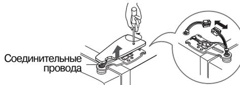
2) Снимите держатель, поворачивая его по часовой стрелке (1), а затем поднимите верхнюю петлю (2).
