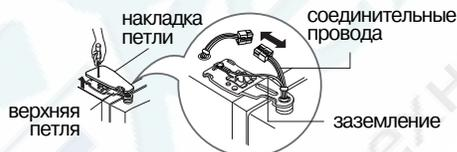
2) Снимите держатель, поворачивая его по часовой стрелке (1), а затем поднимите верхнюю петлю (2).
